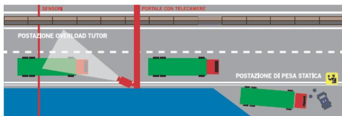
Il sistema di pesa dinamica è collegato tramite la rete UMTS con un portatile in dotazione alla Polizia stradale sul quale vengono visualizzate in sequenza le immagini dei veicoli in sovrappeso rilevati, con data e ora del transito e tempo di arrivo stimato.
